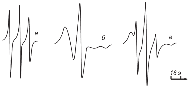
Рис. 14. Спектр ЭПР нитроксильного радикала в бутадиеновом каучуке (а), полистироле (б) и их блоксополимере (в)
