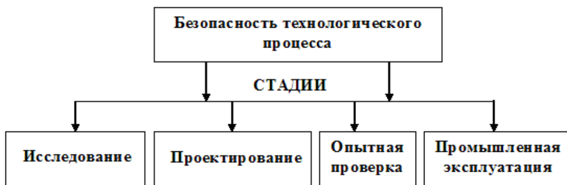
Рис 5. Стадии обеспечения безопасности технологического процесса
