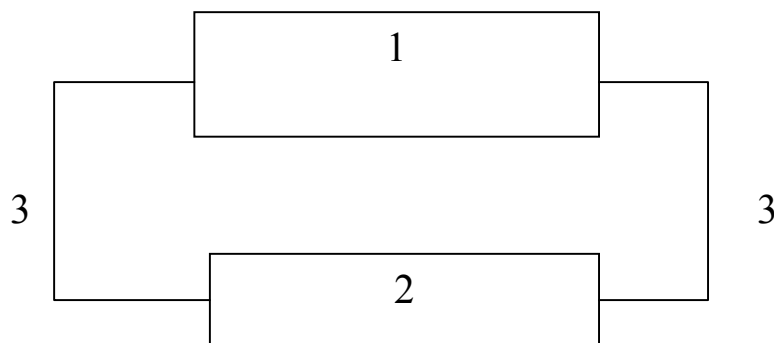
Рис. 6.1. Схема экспериментальной установки: 1 – экспериментальная камера; 2 – комбинированный прибор; 3 – соединительные провода
