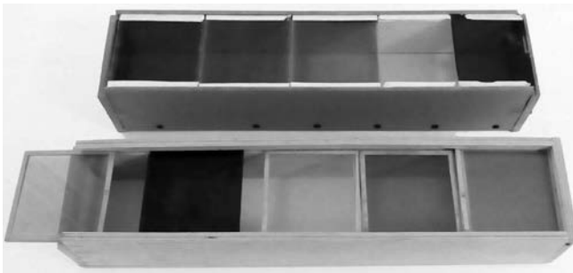
Рис. 9. Учебный аналог спектрального фотоградиент-прибора, используемый на лабораторных занятиях для определения цветного фотопреферендума животных
