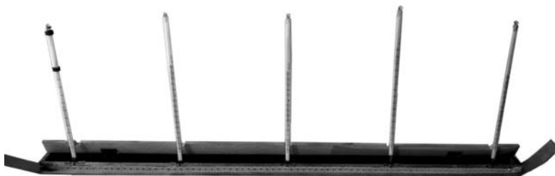
Рис. 2. Учебный аналог термоградиент-прибора, используемый на лабораторных занятиях для определения термотактического оптимума мелких насекомых
